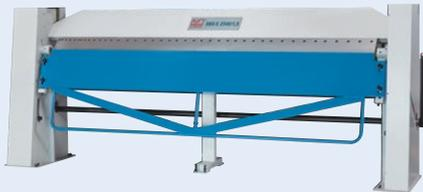
Schwere, manuelle Schwenkbiegemaschine mit segmentiertem Oberwerkzeug und manueller Bombierung für große Arbeitslängen
