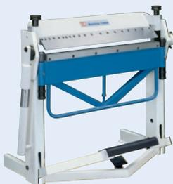
Kompakte, manuelle Schwenkbiegemaschine mit segmentiertem Oberwerkzeug
