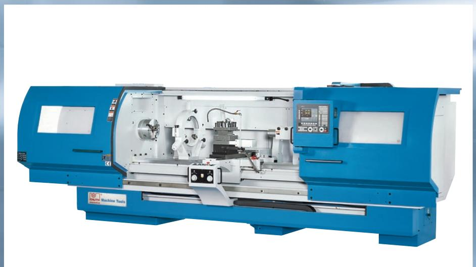
**CNC Flachbett Drehmaschinen**
